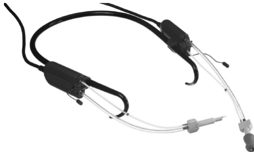
Abbildung 10 Die REM/SPL-Kombination aus Einsteckhörer und Sondenmikrofon
